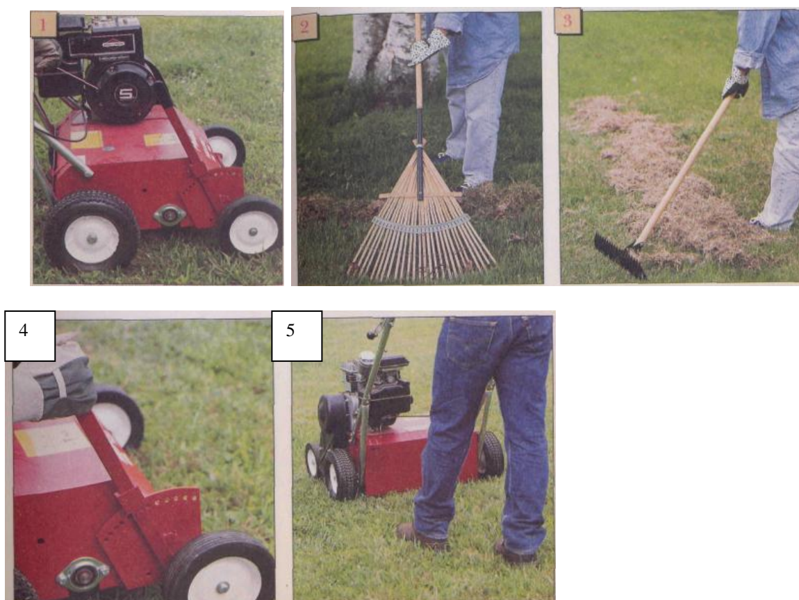
Рисунок 20. Уборка сухой травы: 1 – машина для уборки сухой травы («электрические грабли») используется на газонах значительной площади; 2 – газонные грабли, используются на небольших газонах с тонким слоем сухих остатков (менее 2 см); 3 – веерные грабли, используются на небольших газонах со слоем сухой травы средней толщины (более 2 см); 4, 5 - автоматическая уборка сухой травы при помощи «электрических граблей».
